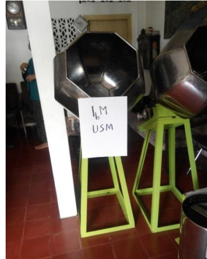
Gambar 7. Mesin pencampur bumbu hasil IbM
